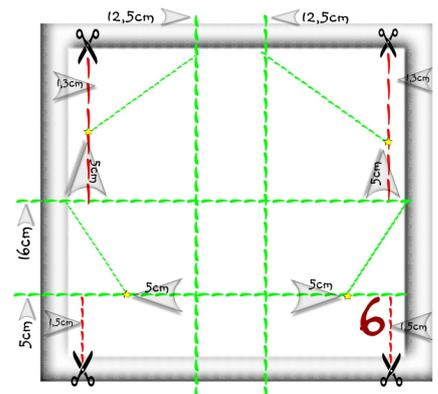
Die roten Linien sind Schnittlinie, die grünen Linien sind Falzlinien. Die Markierungen und schrägen Verbindungen wie in der Grafik und auf Bild 6 ein/an anzeichnen und anschließend wegschneiden. Eure rechte Seite sollte dann wie auf Bild 7 ausschauen. Das Gleiche bitte auf der linken Seite machen.
